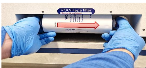
Figur 12.2 Fremgangsmåde for isætning og fjernelse af VOC/HEPA-filteret
