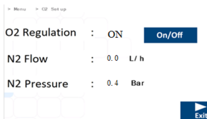
Figur 16.4 Undermenuen Opsætning af N 2 -mængden på MIRI® TL6 og MIRI® TL12 multiroom IVF-inkubatoren
